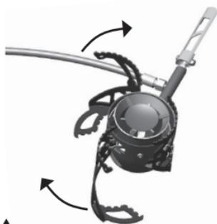
Suelte los soportes para el cazo del quemador. Suelte la válvula de control de combustible y asegúrese de que está en posición de apagado. **2**
