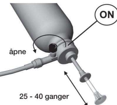
Lufttrykket i brenselflasken er avgjørende for kokeapparatets effekt. Under matlagingen kan du bli nødt til å pumpe ytterligere for å holde maksimal effekt. Pumper du opp for høyt trykk, får du for høy brenselgjennomstrømming, hvilket gir gule flammer.
